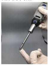
在重新组装分散头过程中,一定要保护PTFE(特氟龙)垫圈的正确安装。在开机使用时务必保证分散头处于液体介质中以冷却PTFE垫圈,并定期检查垫圈的状态。分散头是分散器的核心,要小心操作,防止损伤,特别小心保护转子杆。
