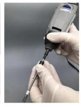
将套爪夹头重新安装回去,注意同时按下蓝色自锁按钮同时旋紧套爪夹头。
