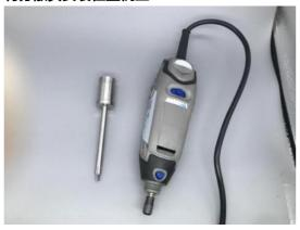
按住主机前端自锁蓝色按钮,同时旋松套爪夹头
