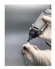
取掉套爪夹头,将转子轴插入套爪夹头中心孔内。注意:请将黑色弹性夹套转子轴中部移动,确保转子轴完全固定。
