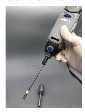
将定子套杆旋入主机。压下蓝色自锁按钮同时紧固定子套杆。
